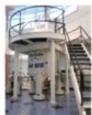
Spettrometro NMR 28.2 Tesla
